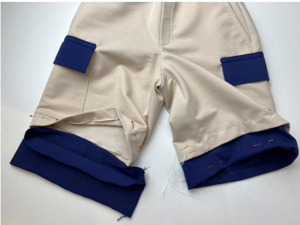
Застрочите низ шорт на распошивальной машине, одновременно фиксируя положение планки.
