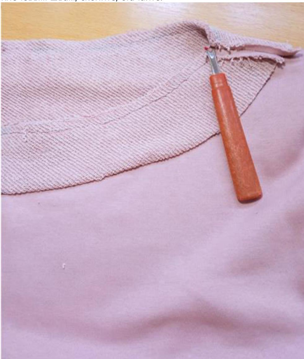
Припуски шва обтачивания горловины отверните в сторону обтачки и отстрочите в край по лицевой стороне обтачки.
