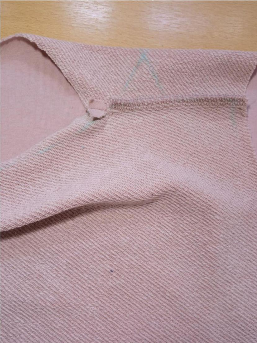
Обметайте срез горловины вкруговую. Заметайте его на ширину припуска в сторону изнанки.
