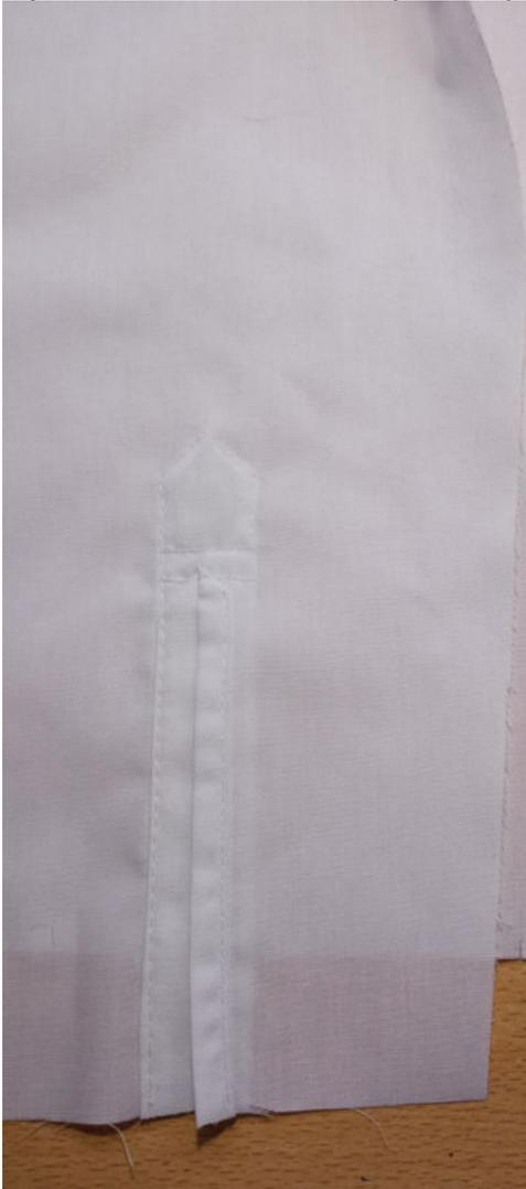
Притачайте планки разрезом к срезам передней части рукавов. Настрочите поперечные закрепки.
