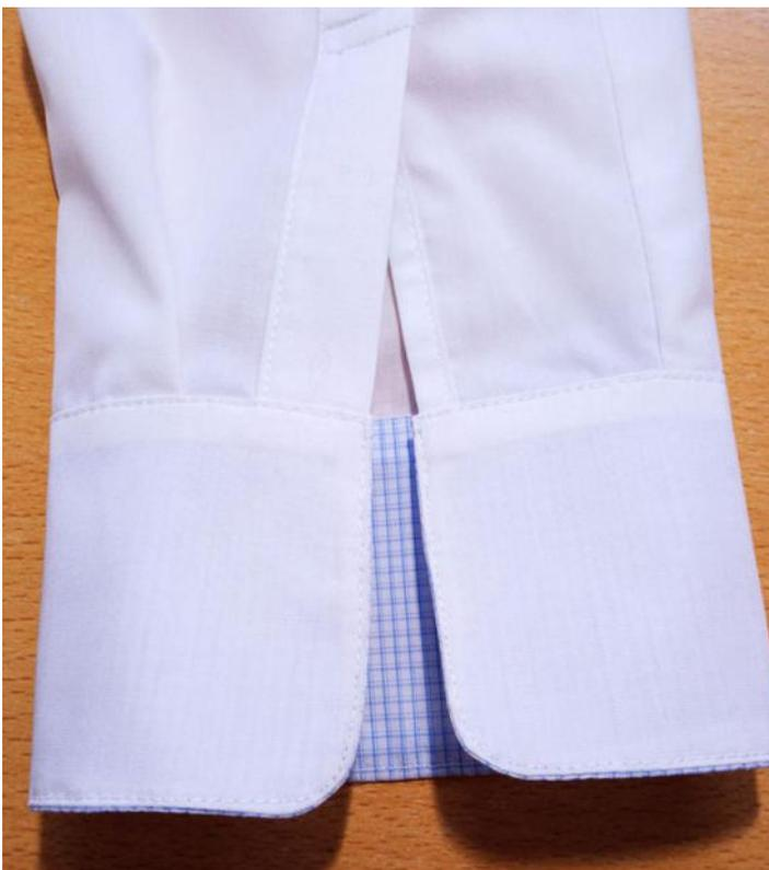
Концы планок отверните на лицевую сторону, обтачайте на ширину подгибки низа. Припуски швов в уголках высеките наискосок, не доходя до строчки 0,2 см.
