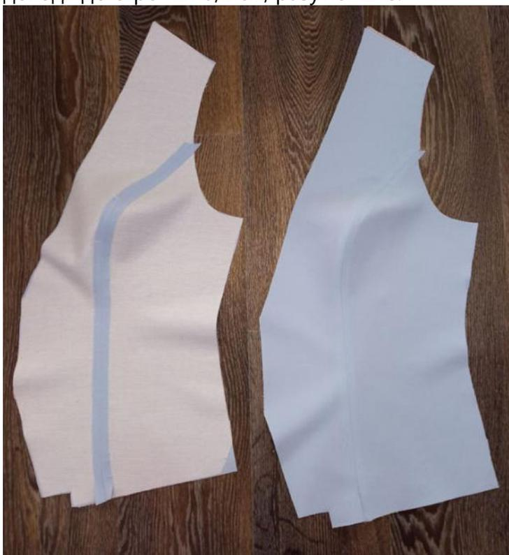
Стачайте детали спинки между собой. Припуски швов на скруглениях рассеките, не доходя до строчки 0,2 см, разутюжьте.
