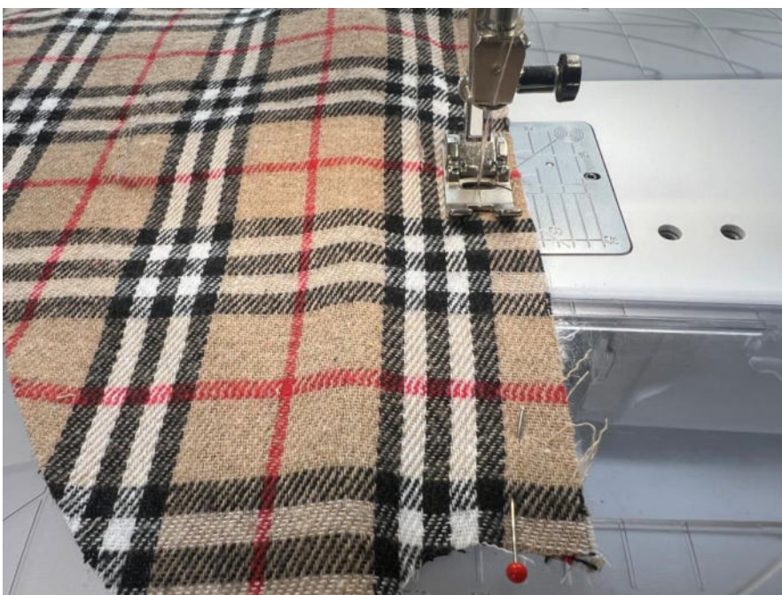
Припуски шва заужьте в сторону планки.
