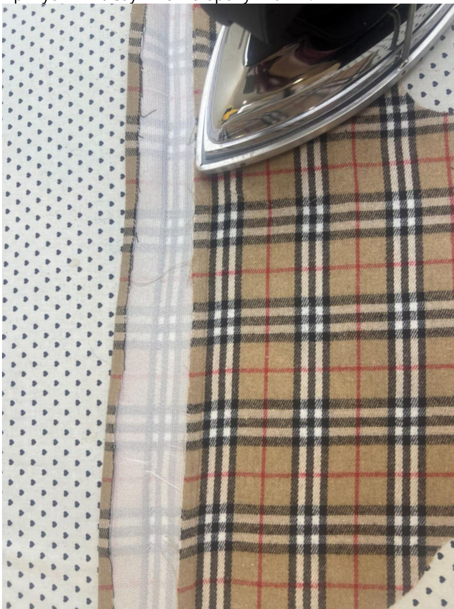
Припуски шва заужьте в сторону планки.
