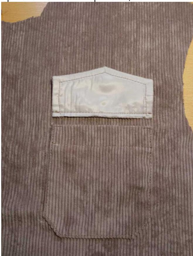
Отверните клапан вниз и еще раз настрочите на изделие швом шириной 0,7 см. Приутюжьте клапан.
