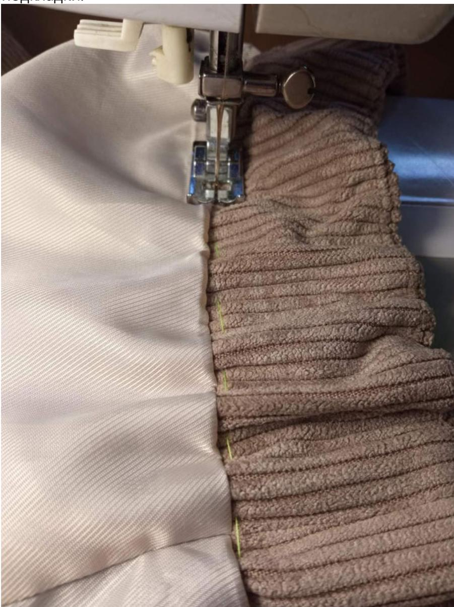
Равномерно растягивая резинку, отстрочите низ изделия двумя параллельными строчками.
