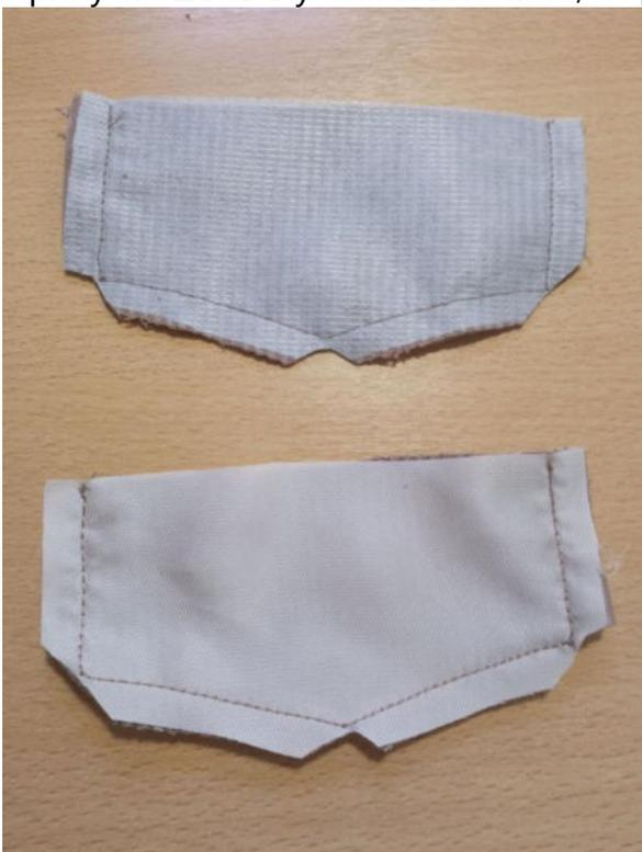
Выверните, выправьте клапаны на лицевую сторону, выметайте с переходным кантом шириной 0,1-0,2 см из верхнего клапана в сторону его подкладки, приутюжьте.
