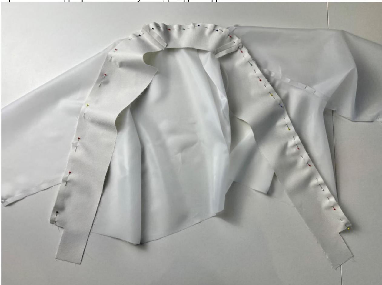
Стачайте детали между собой. Припуски шва на скруглениях рассеките, не доходя до строчки.
