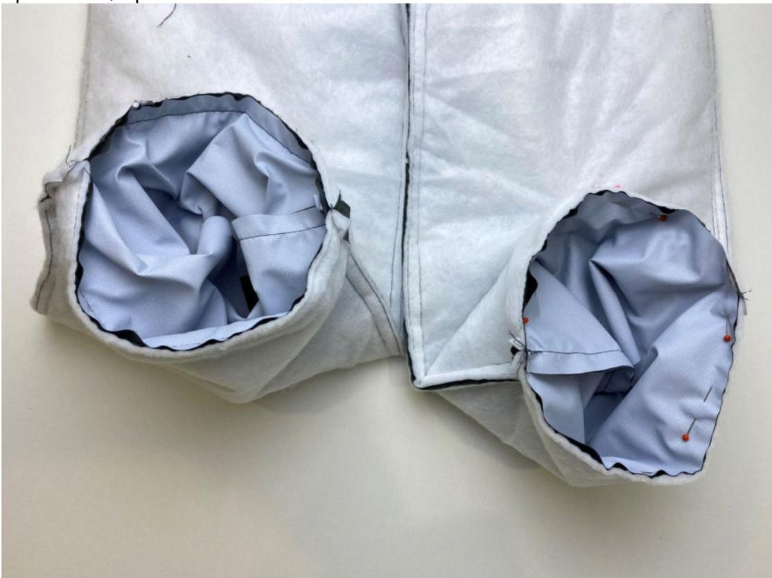
Выверните, выправьте нижние части подкладки брюк на лицевую сторону, булавками или зажимами зафиксируйте переходный кант шириной 0,1-0,2 см из изделия в сторону подкладки.
