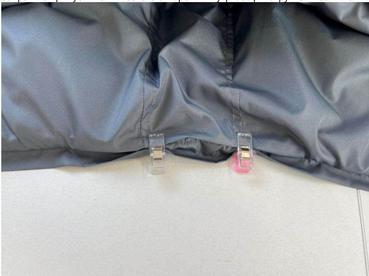
Отстрочите низ капюшона и одновременно застрочите техническое отверстие.
