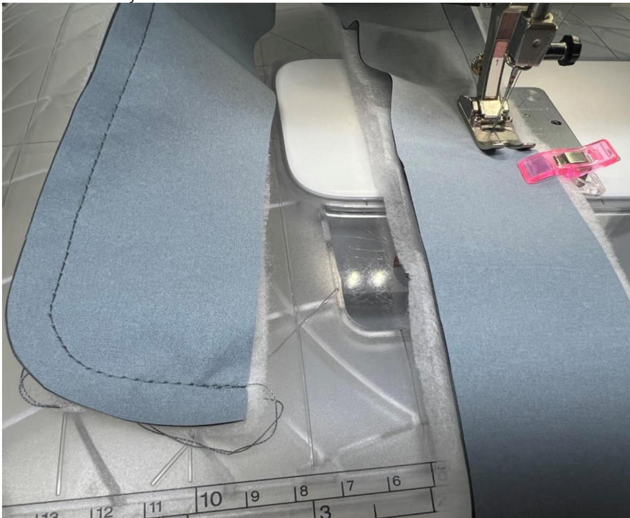
Высеките припуски утеплителя близко к строчке. Припуски шва на скруглениях рассеките, не доходя до строчки 0,2 см.
