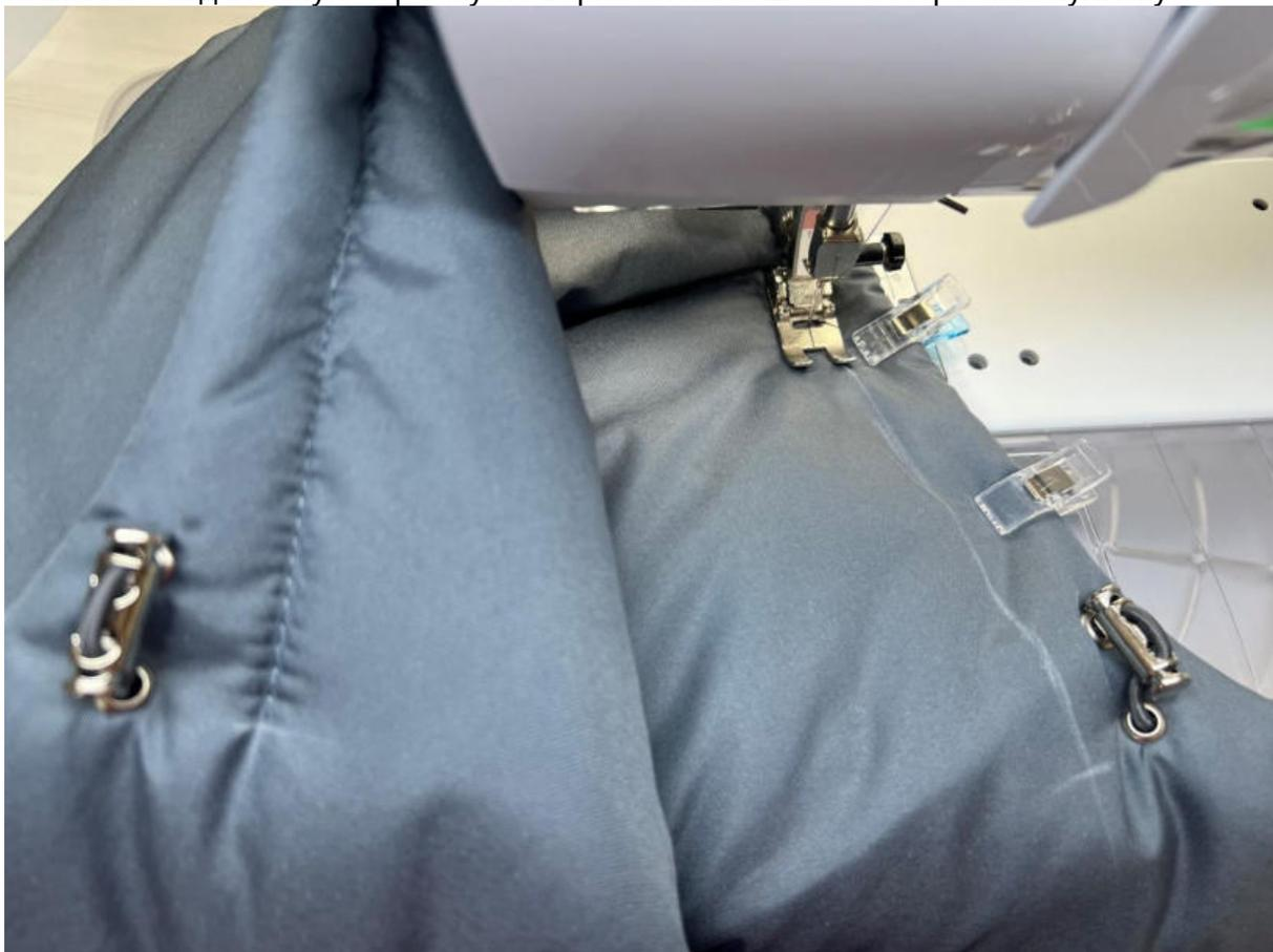
Заправьте припуски технического отверстия внутрь. Зафиксируйте их зажимами.
