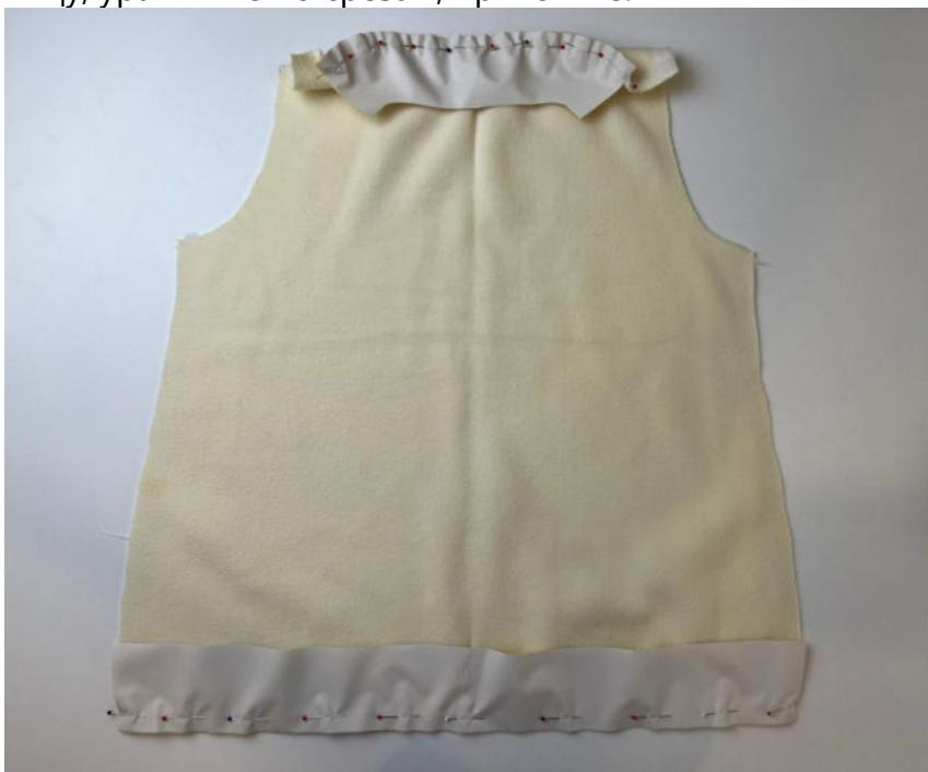
Притачайте обтачки к подкладке спинки. Припуски швов на скруглениях рассеките, не доходя до строчки 0,2 см. Отверните припуски швов в сторону обтачек. Отстрочите швы на ширину лапки по лицевой стороне обтачек.
