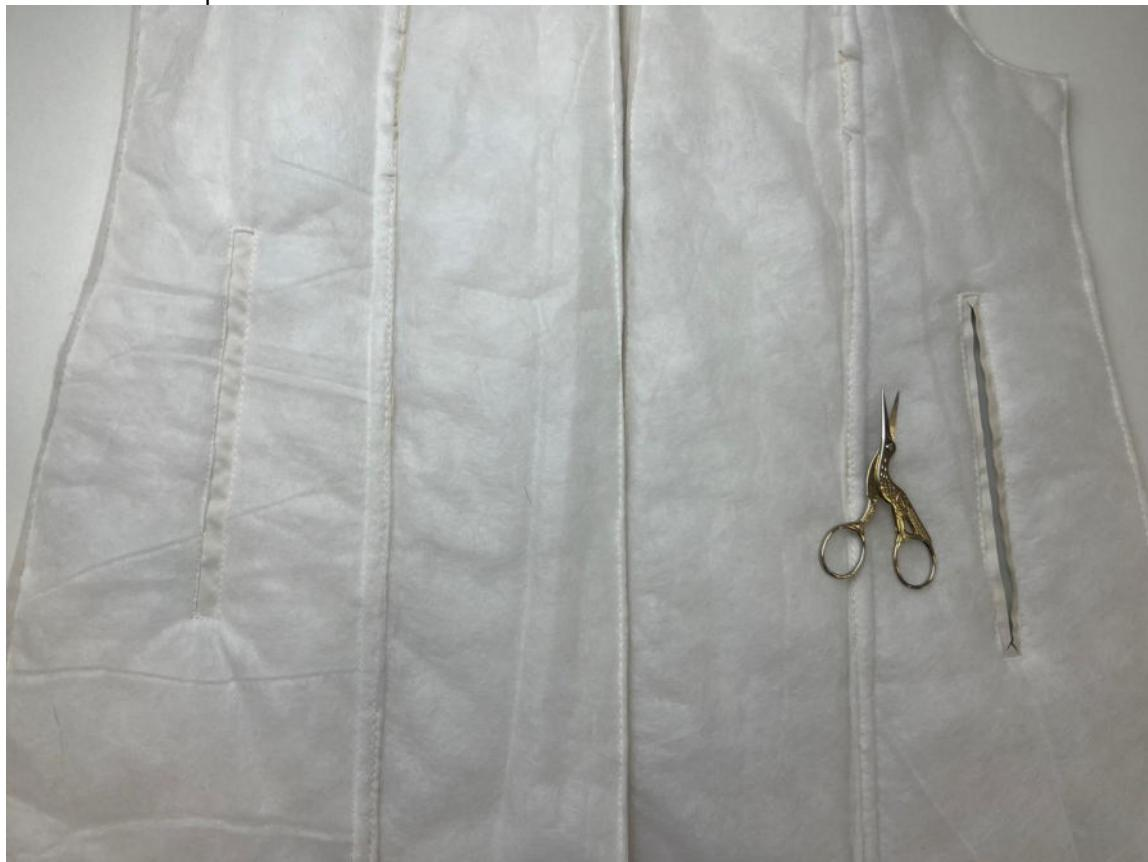
Выверните, выправьте мешковину кармана в сторону изнанки переда, зафиксируйте зажимами по шву обтачивания рамки, фиксируя переходный кант шириной 0,1-0,2 см из изделия в сторону мешковины.
