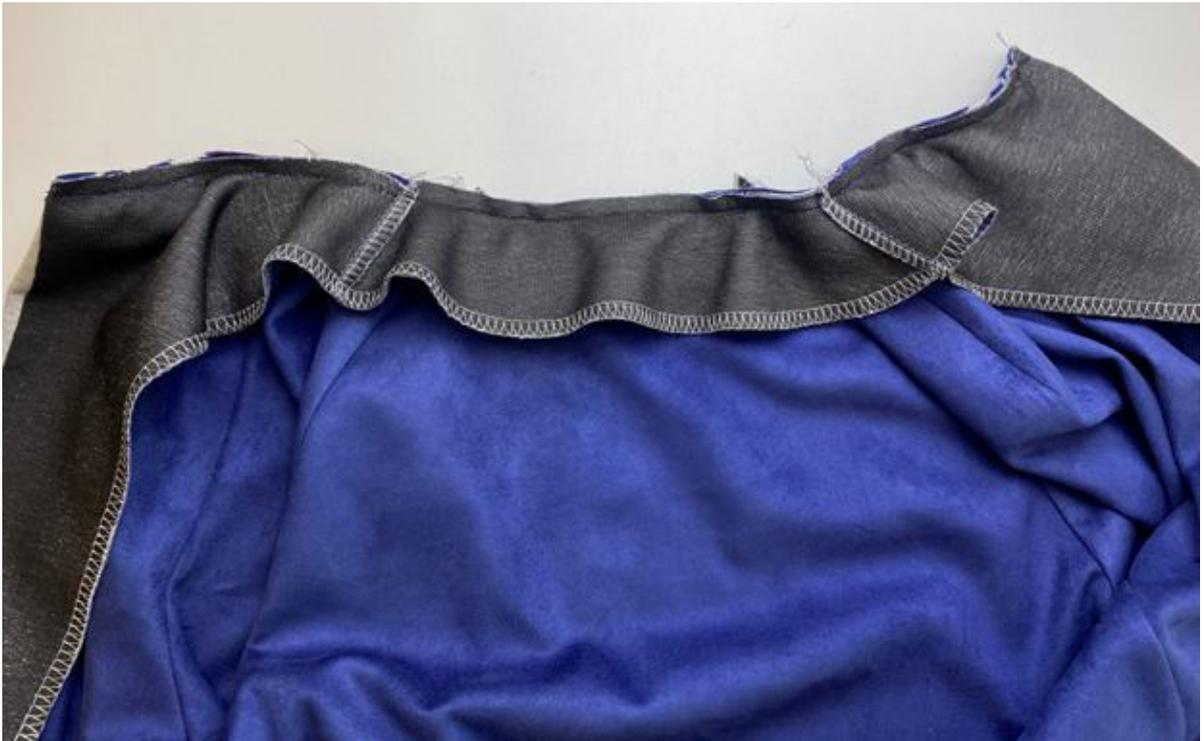
Припуски шва горловины отверните в сторону подбортов и обтачки и отстрочите в край по их лицевой стороне, начиная от участка втачивания воротника с одной стороны, и заканчивая участком втачивания воротника с другой стороны горловины.
