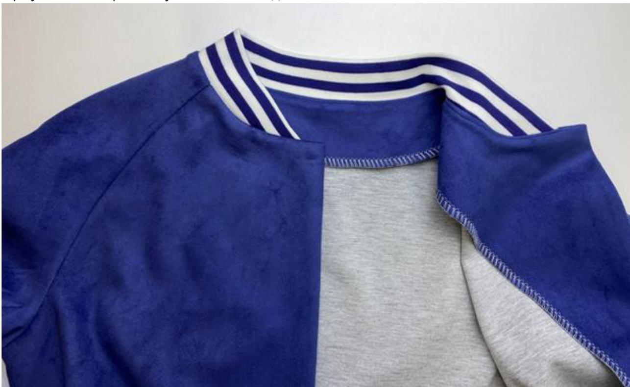
Ручными потайными стежками подшейте отлетные края обтачки к припускам швов втачивания рукавов в проймы и к припускам вытачек рукавов.
