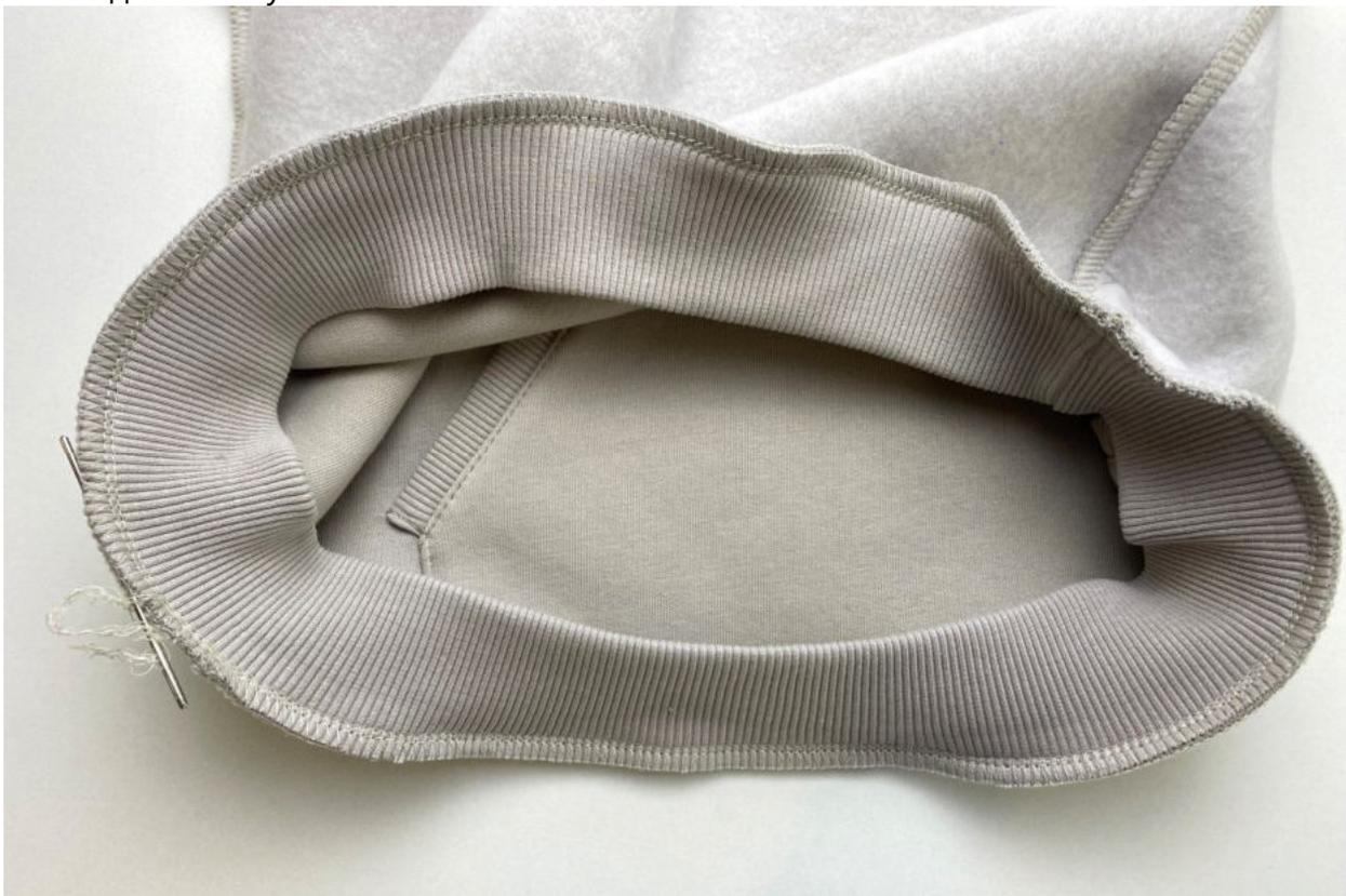
Припуски шва приутюжьте на ребро, затем заутюжьте в сторону изделия.
