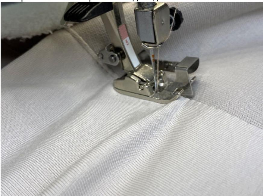
Сложите капюшон и подкладку вместе, изнанкой к изнанке, с перекантом шириной 2 мм из капюшона в сторону подкладки, приутюжьте.
