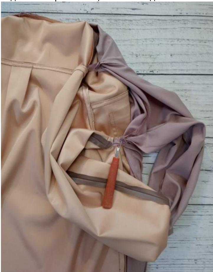
Выверните изделие через отверстие в боковом шве подкладки. Подпорите один из швов в подкладке рукава.
