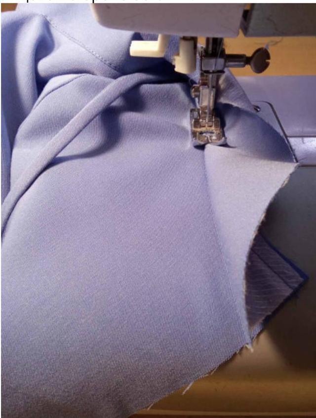
Отверните обтачку в сторону изнанки переда. Выметайте шов с переходным кантом шириной 0,1-0,2 см из изделия в сторону обтачки. Приутюжьте. Обметайте нижний срез обтачки.
