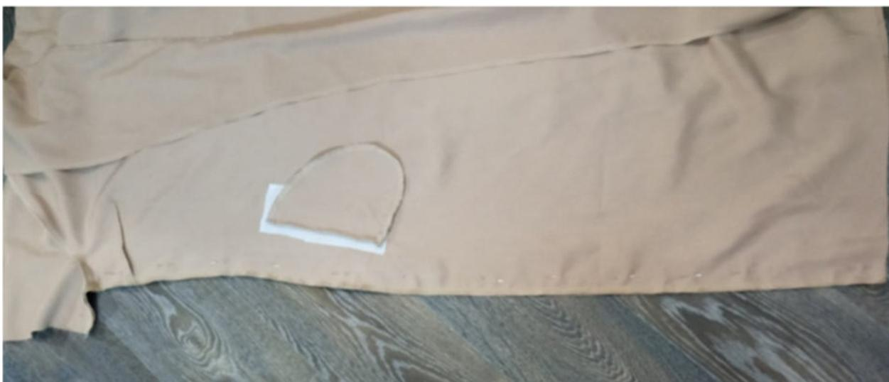
Ориентируясь на ширину подгибки низа платья, обтачайте нижние углы подбортов. Припуски швов в уголках высеките наискосок, не доходя до строчки 2 мм.
