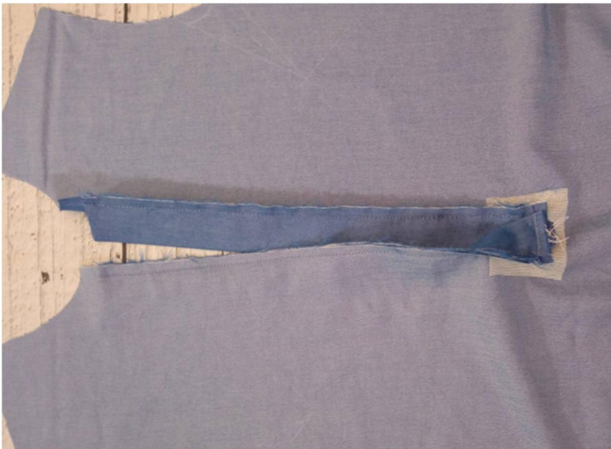
Вкруговую обметайте припуски швов притачивания планок. Приутюжьте.
