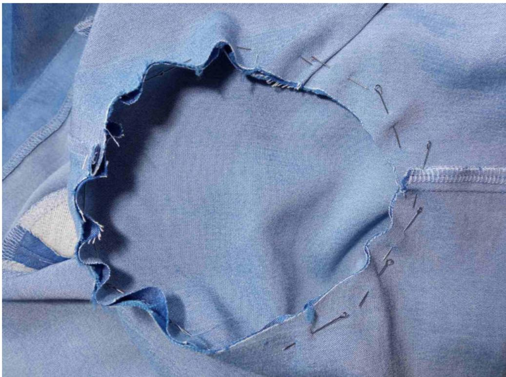
Втачайте рукав в пройму. Припуск шва обметайте, приутюжьте на ребро.
