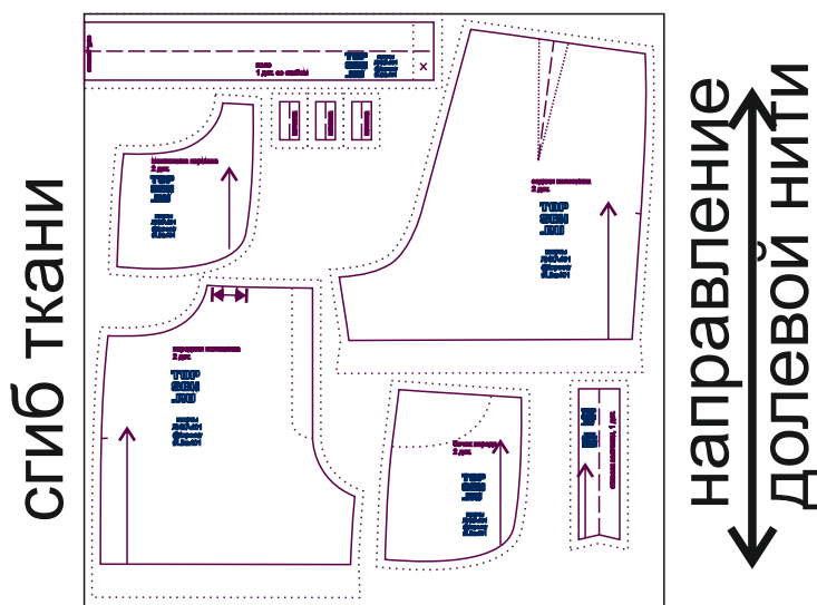
Пример раскладки деталей изделия из основного материала
