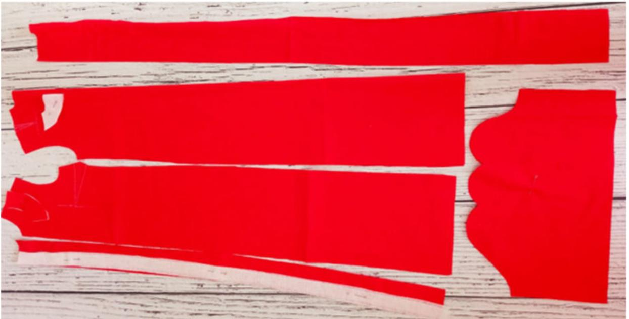
Наметьте расположение вытачек на деталях переда и спинки. Сметайте, стачайте их. Плечевые вытачки на спинке заутюжьте к центру детали, нагрудные вытачки на деталях переда – вниз.
