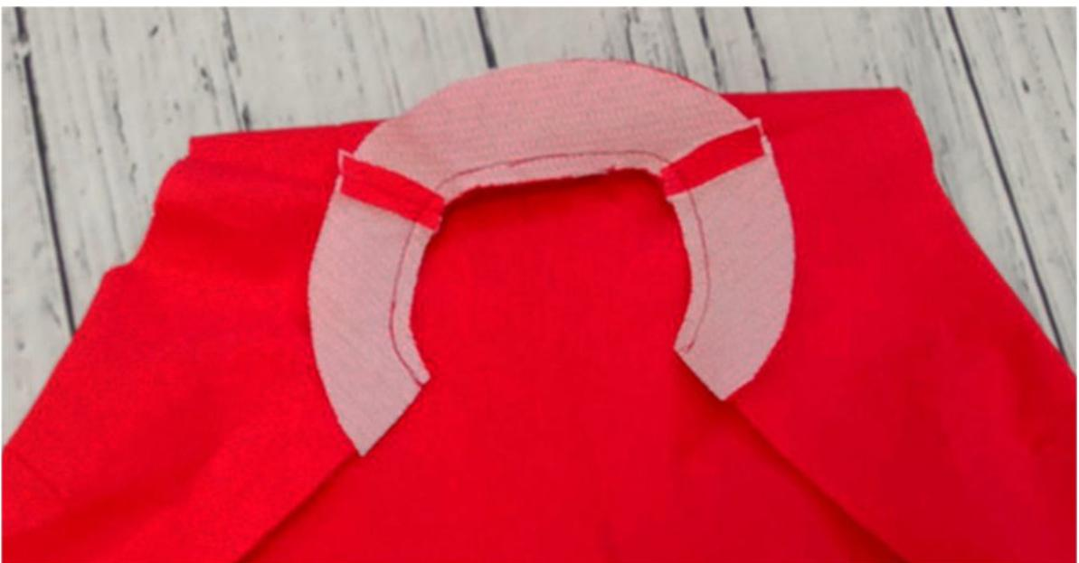
Припуск шва обтачивания настройте на обтачку на расстоянии 1-2 мм от стачивающей строчки.
