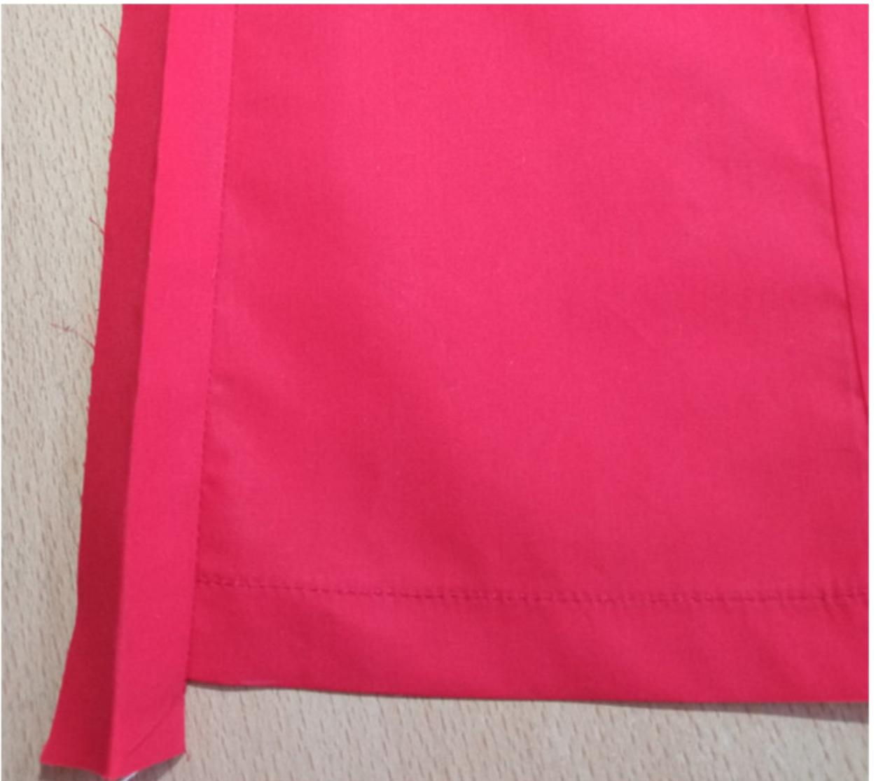
Отверните верхние и нижние концы планок на лицевую сторону, обтачайте. Припуски швов в уголках высеките наискосок, не доходя до строчки 2 мм.
