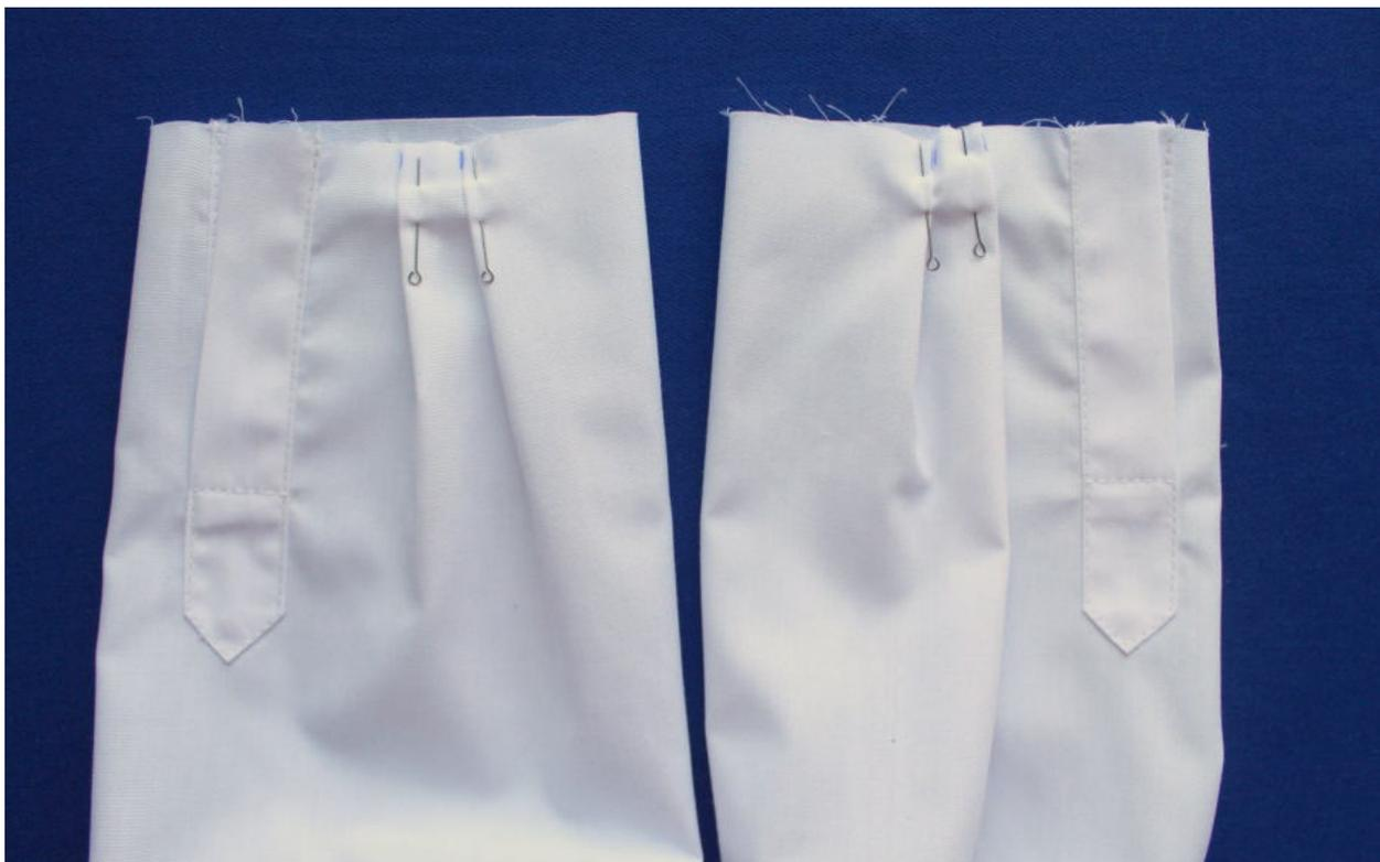
Зафиксируйте положение складок по низу рукавов вспомогательными строчками.
