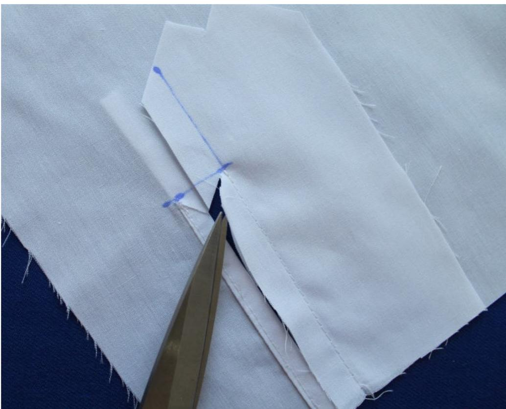
Перегните свободный срез планки в сторону разреза, приутюжьте сгиб строго по центру.
