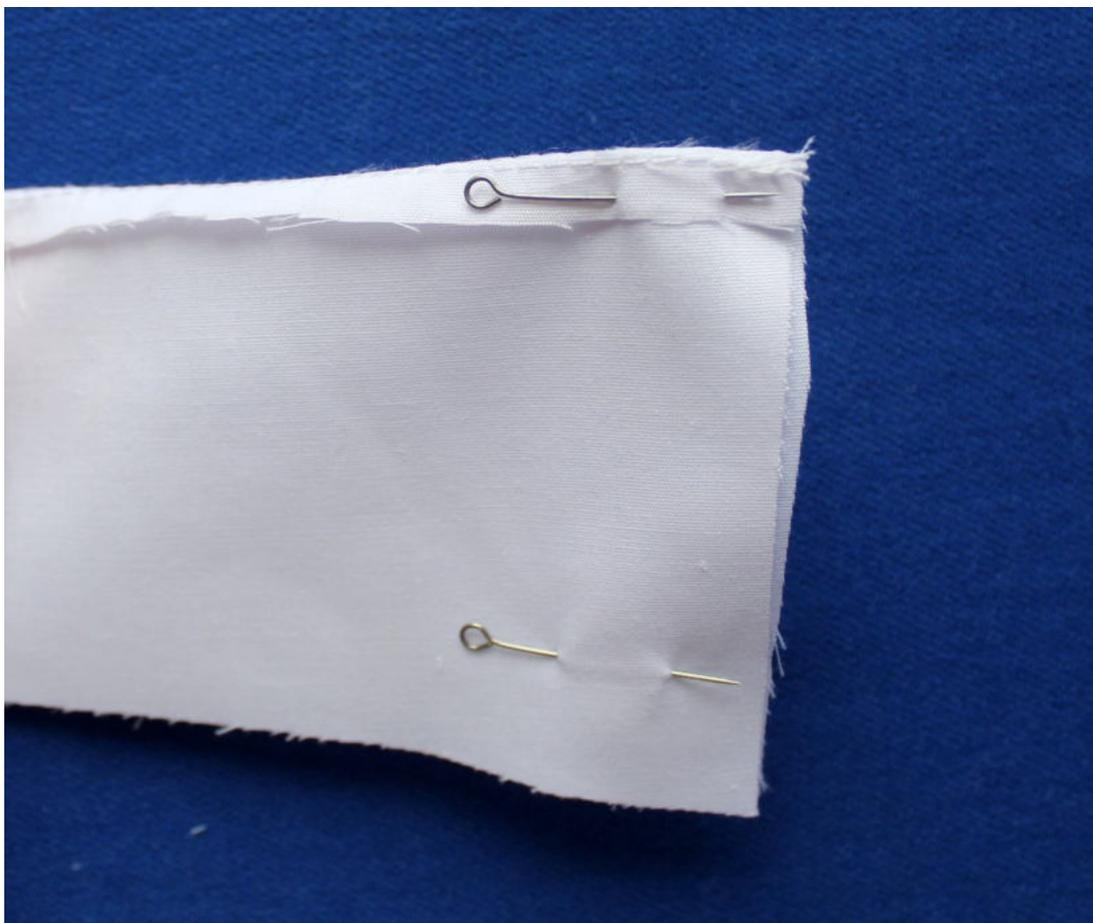
Стачайте срезы на ширину припуска. Припуски швов в уголках высеките, не доходя до строчки 2 мм.
