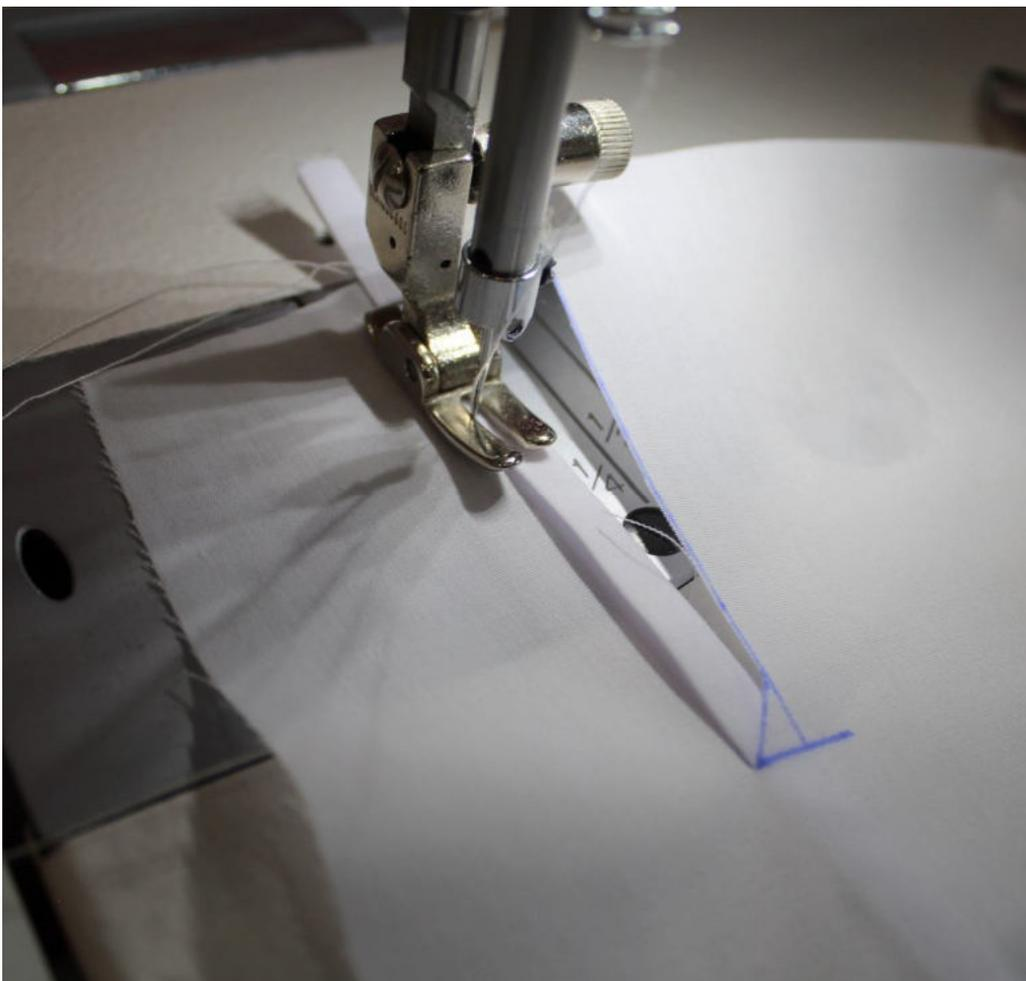
Наложите планку на рукав, лицом на изнанку, уравняйте со срезом разреза рукава, притачайте до отметки верха разреза. Припуски шва приутюжьте.
