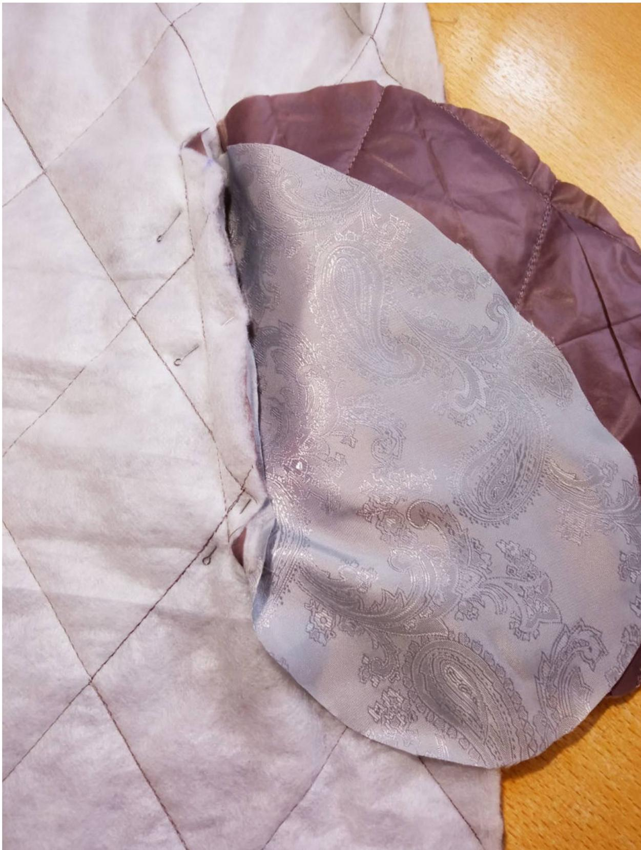
Отверните мешковину из подкладки так, как она будет лежать в готовом кармане. Отстрочите нижнюю часть рамки кармана насквозь, прихватывая мешковину в шов.
