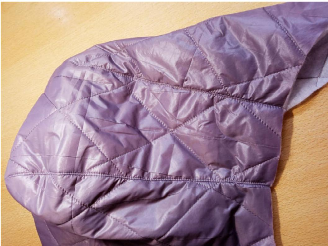
Припуски швов на капюшоне из подкладки заутюжьте в сторону центральной части капюшона.
