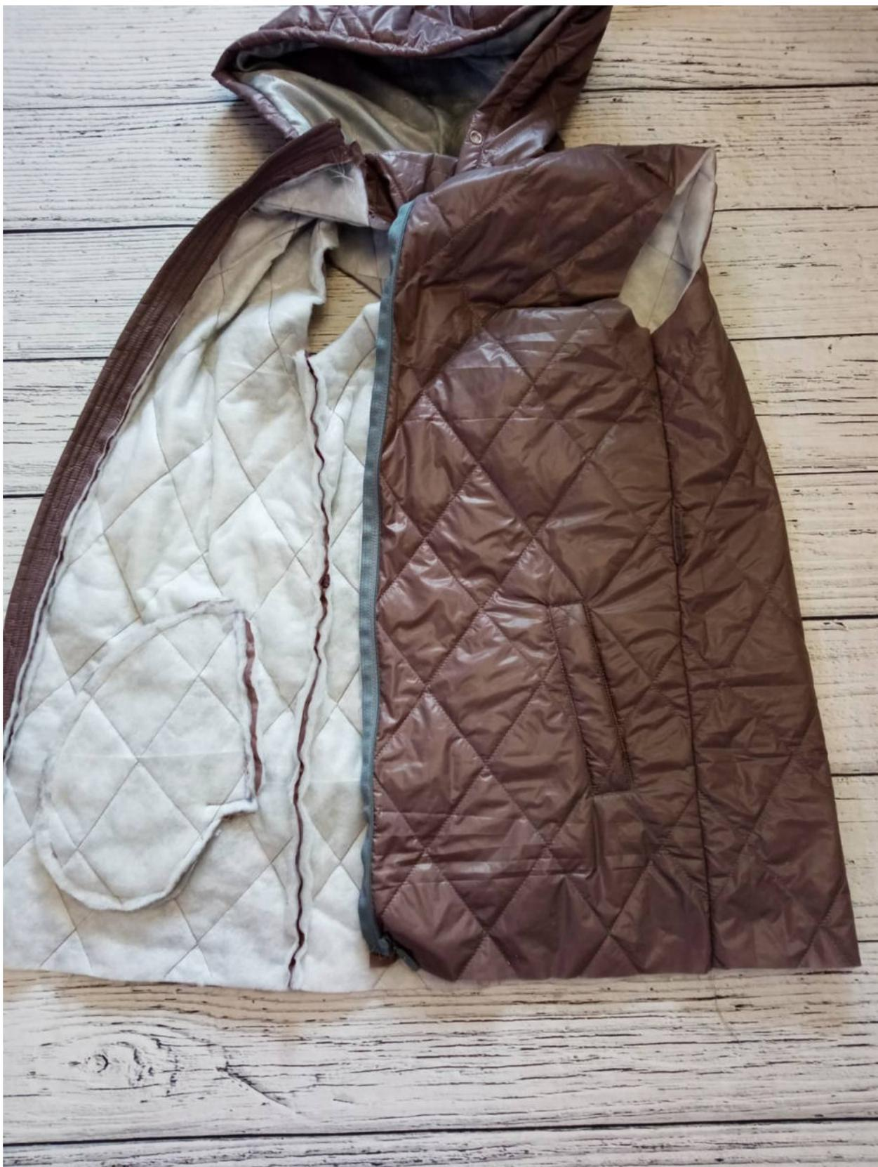
К деталям из подкладки притачайте обтачки из материала верха. Швы приутюжьте, направляя припуски в сторону подкладки.
