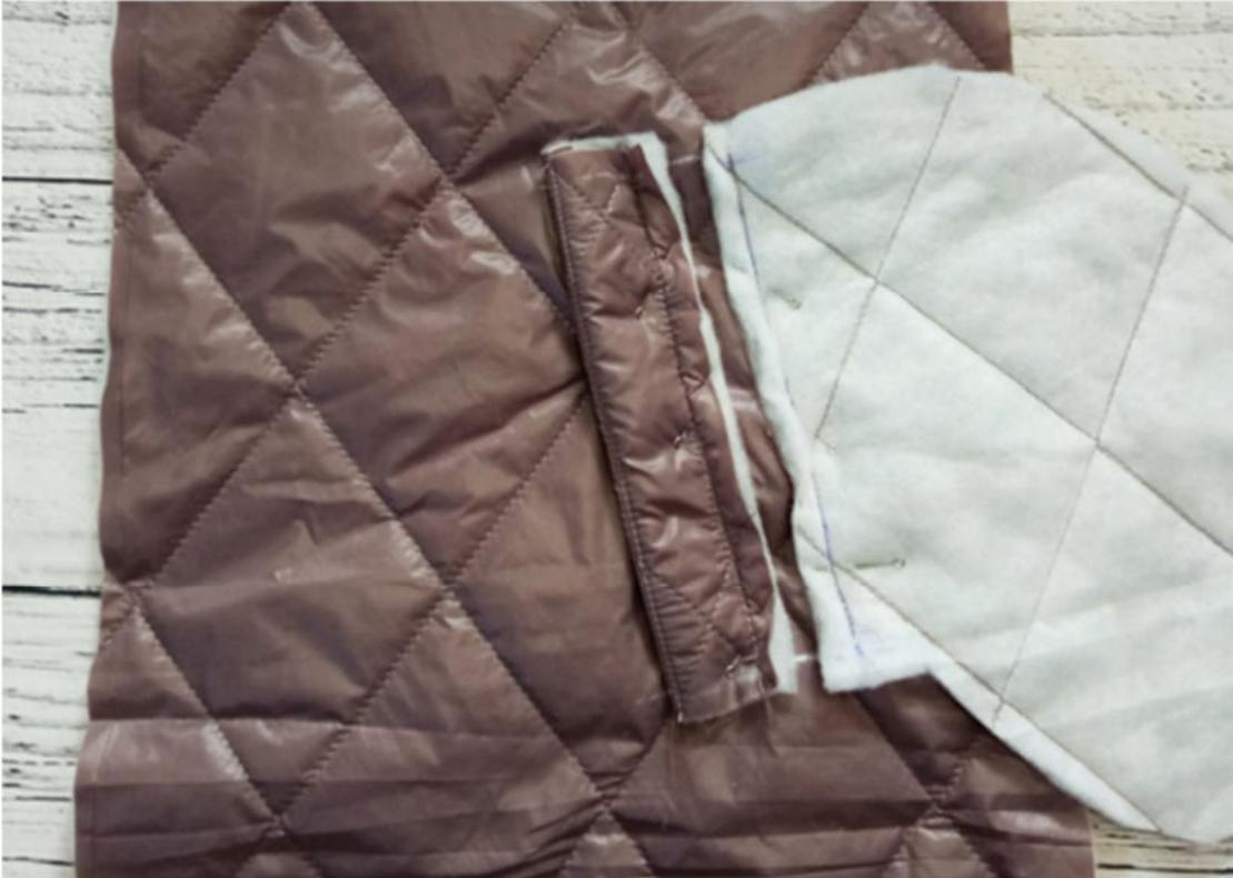
С изнанки переда проверьте параллельность и длину строчек. Разрежьте вход в карман строго посередине между строчками, к концам строчек выходя наискосок, не доходя до них 2 мм.
