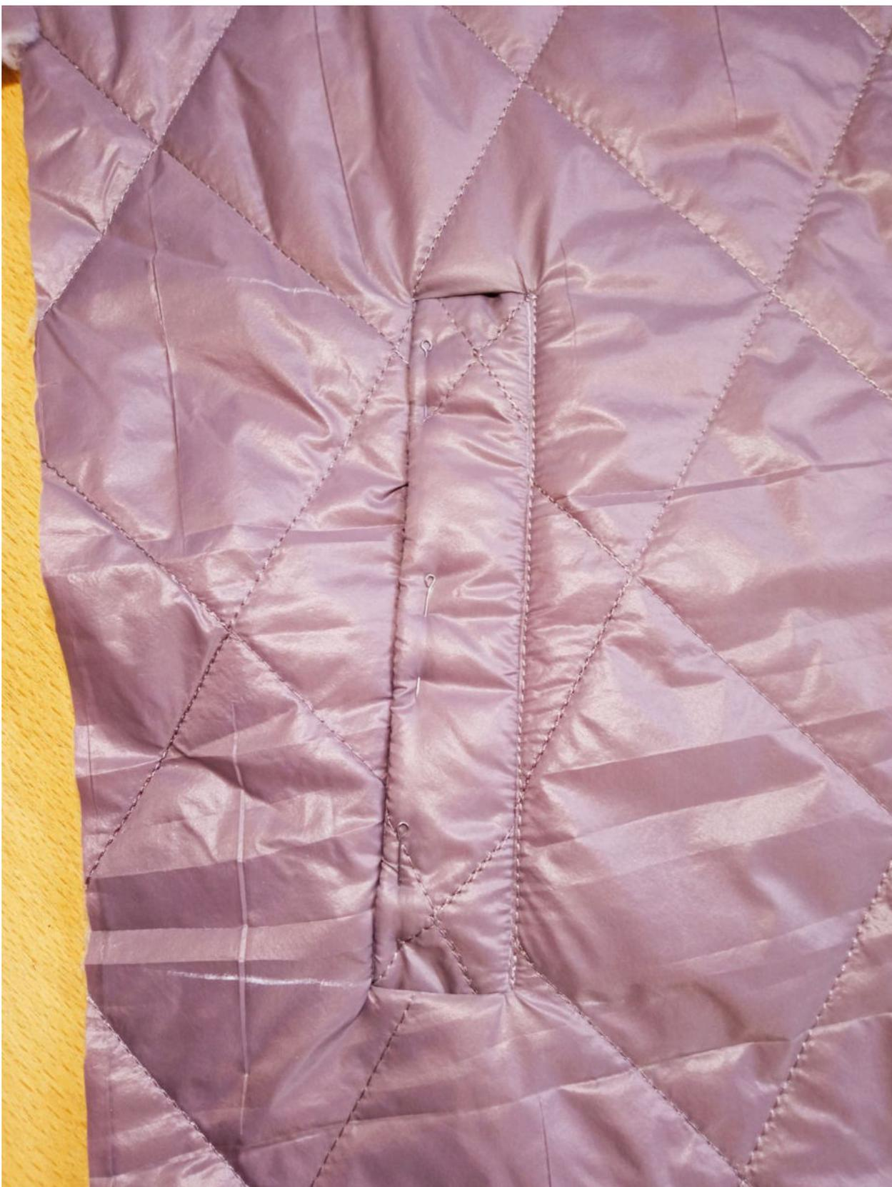
Закрепите строчкой уголки кармана с изнанки детали переда.
