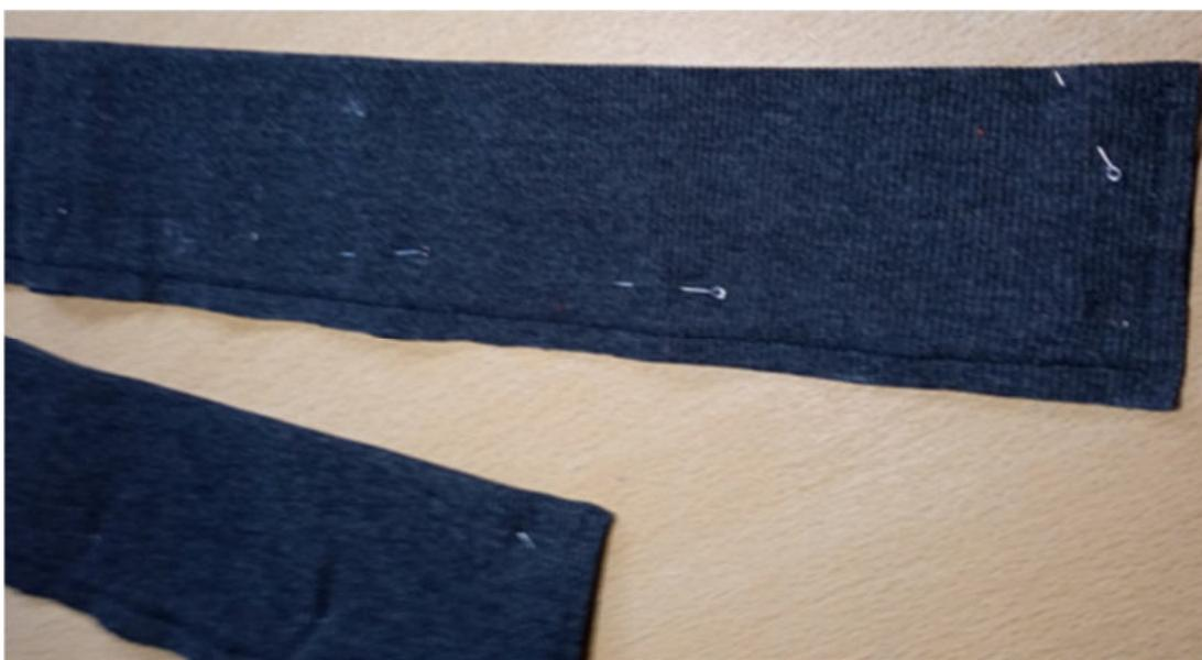
Рассеките припуски в уступе уголков по низу деталей переда.
