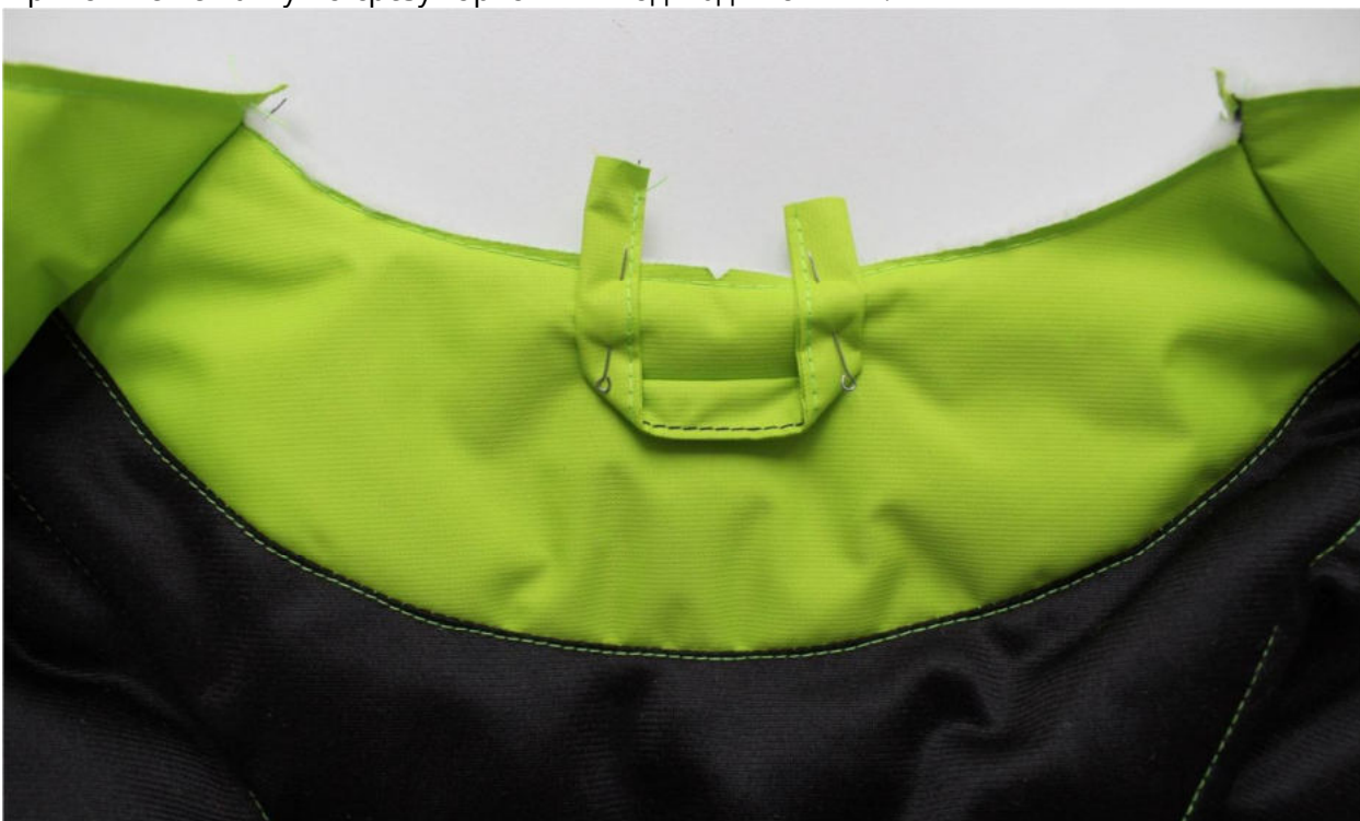
Притачайте вешалку закрепочными строчками.
