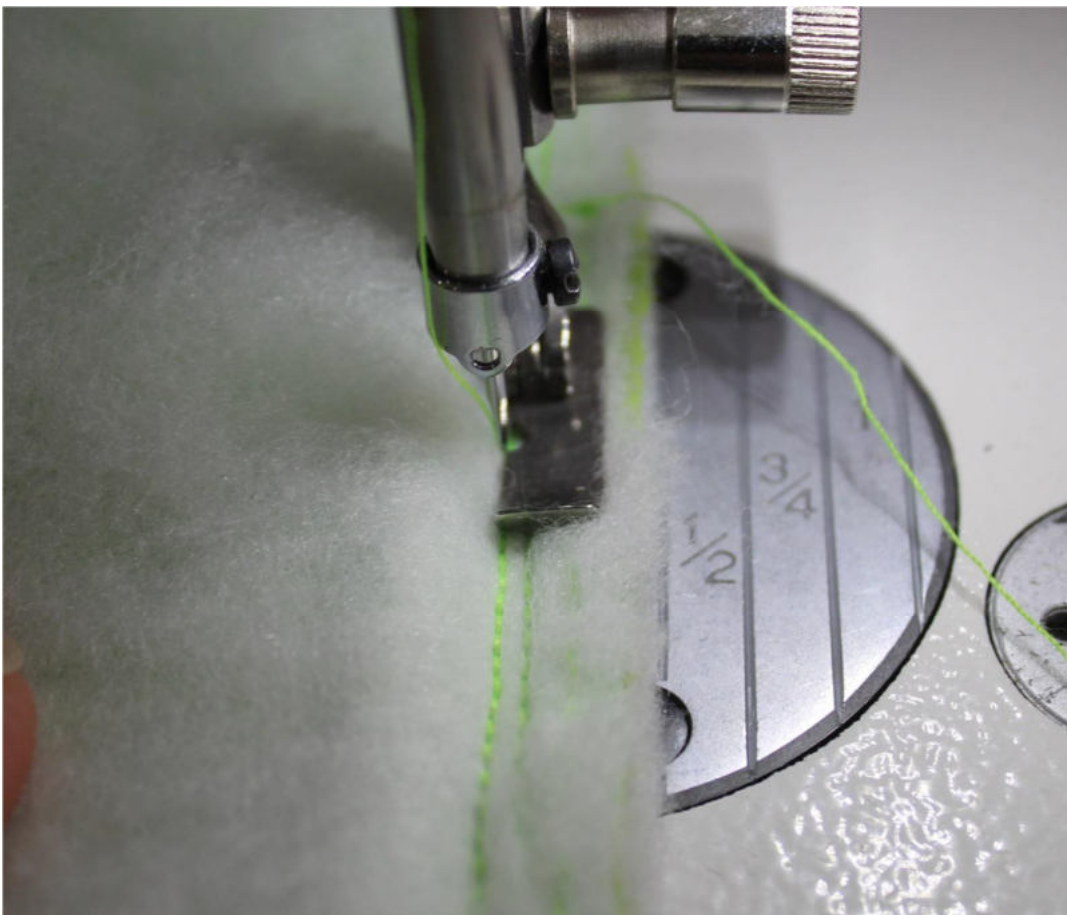
Однорожковой лапкой притачайте подкладку к изделию, попадая в строчку притачивания молнии.
