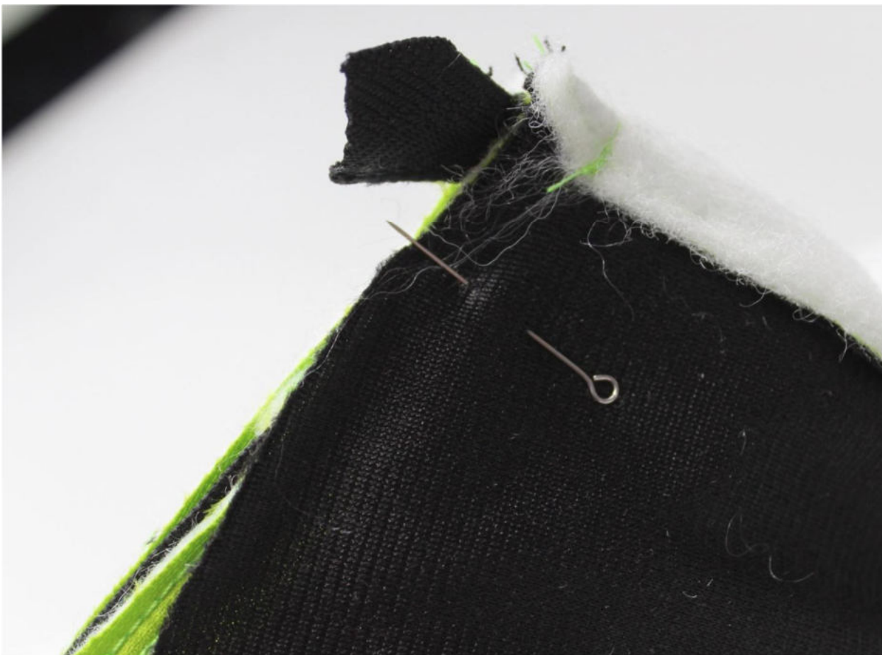
Однорожковой лапкой притачайте подкладку к изделию, попадая в строчку притачивания молнии.
