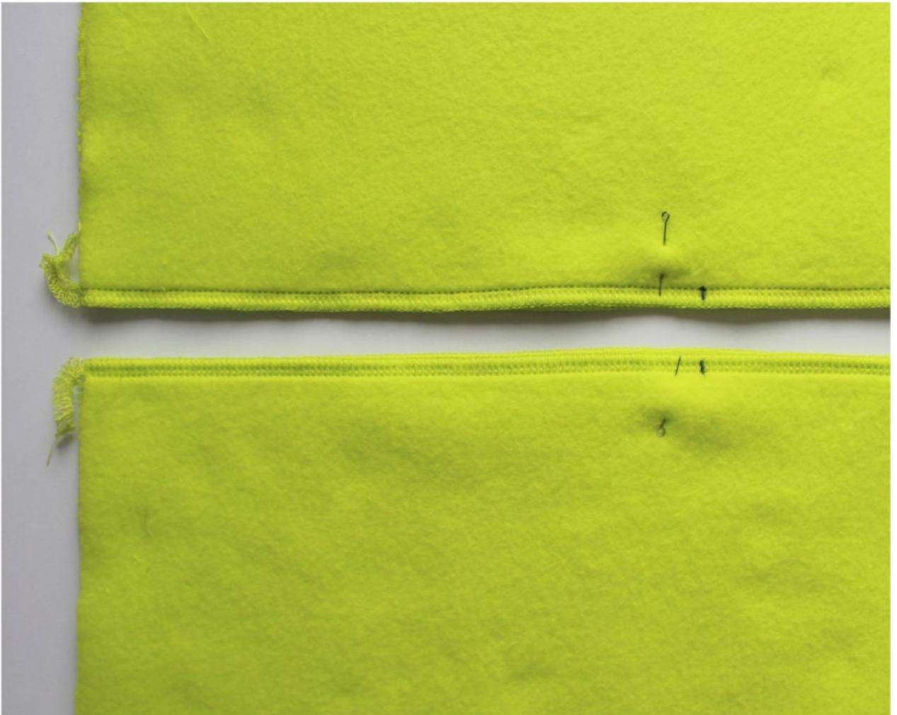
Стачайте срезы рельефов передних половинок брюк на распошивальной машине цепным стежком или на обычной машине эластичной строчкой.
