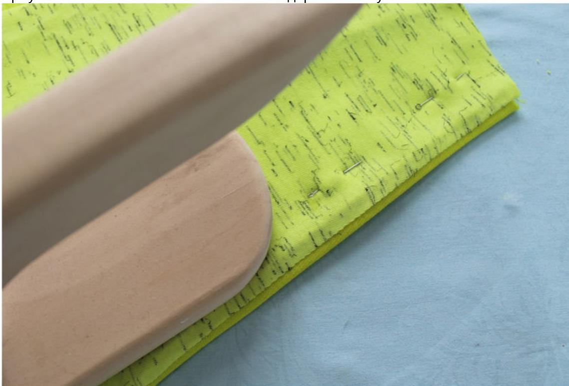
Отстрочите вход в карман на расшивальной машине цепным стежком или на стачивающей машине любой эластичной строчкой. Приутюжьте.
