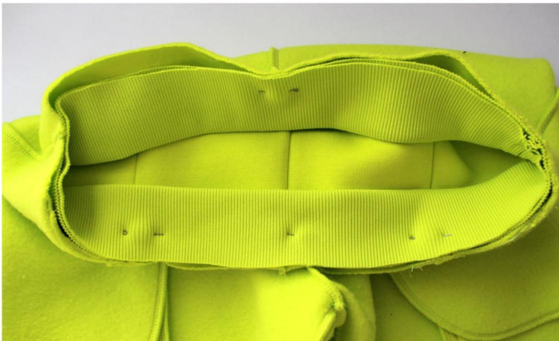
Слегка растягивая, притачайте пояс к изделию оверлочной строчкой. Припуски шва приутюжьте на ребро, а затем заутюжьте в сторону изделия.
