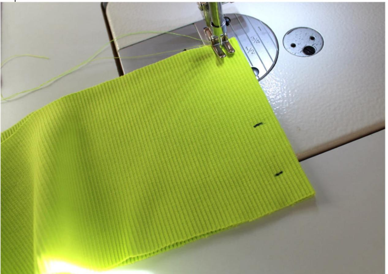
Припуски шва разутюжьте. Отстрочите отверстие под резинку по его периметру.
