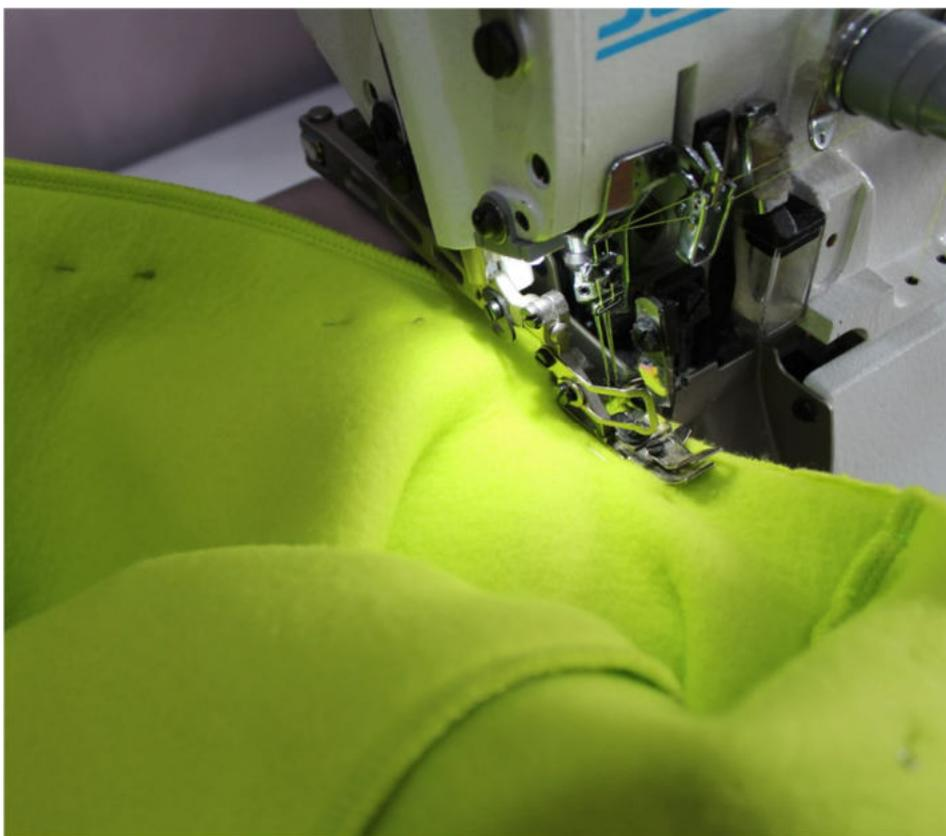
Для удобства перед началом стачивания можно зафиксировать стык шаговых швов ручной закрепкой.
