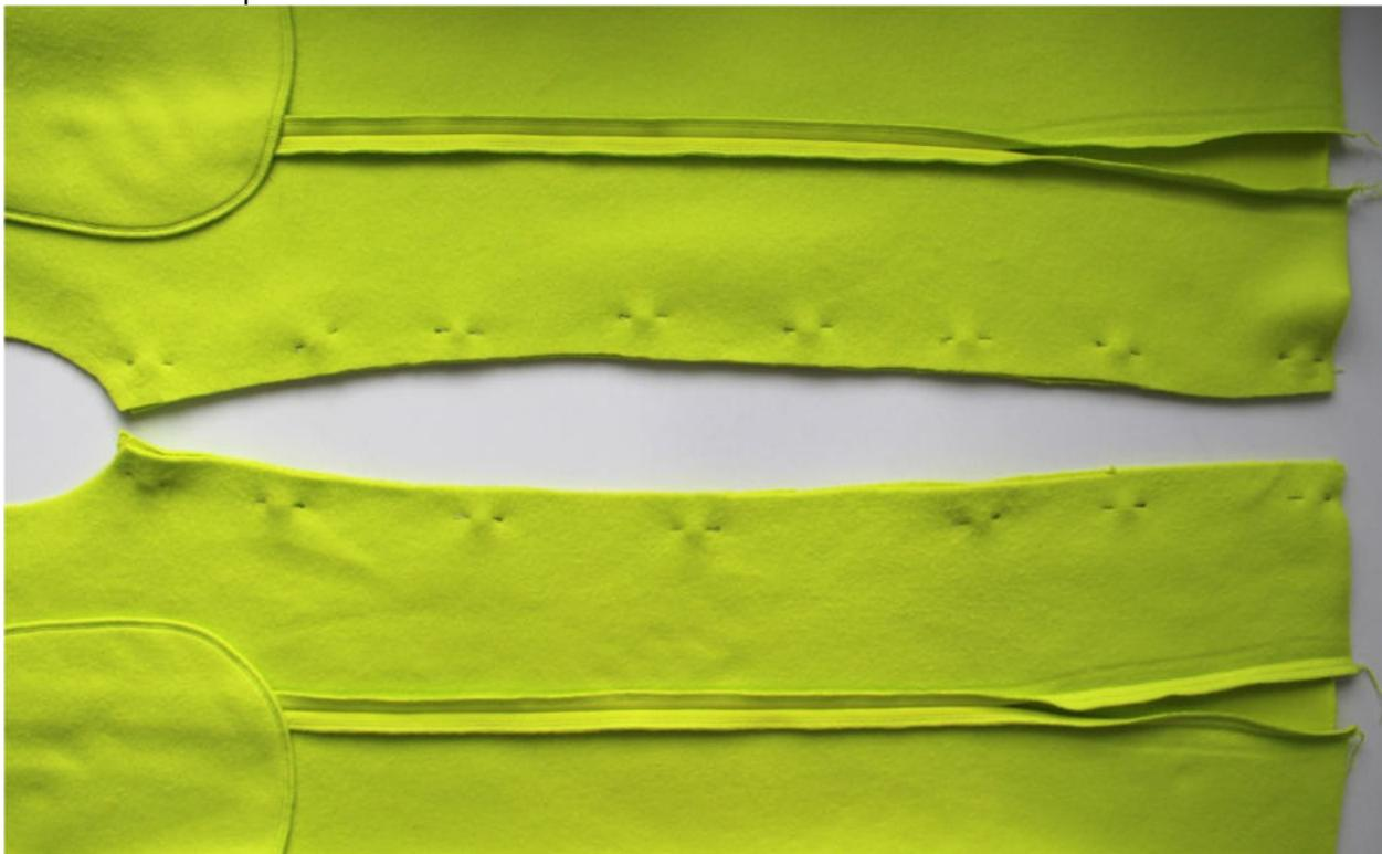
Стачайте срезы на оверлоке. Припуски шва приутюжьте на ребро, а затем заутюжьте в сторону спинки. Для удобства можно воспользоваться рукавной или брючной колодкой с удлинённым валиком для ВТО.
