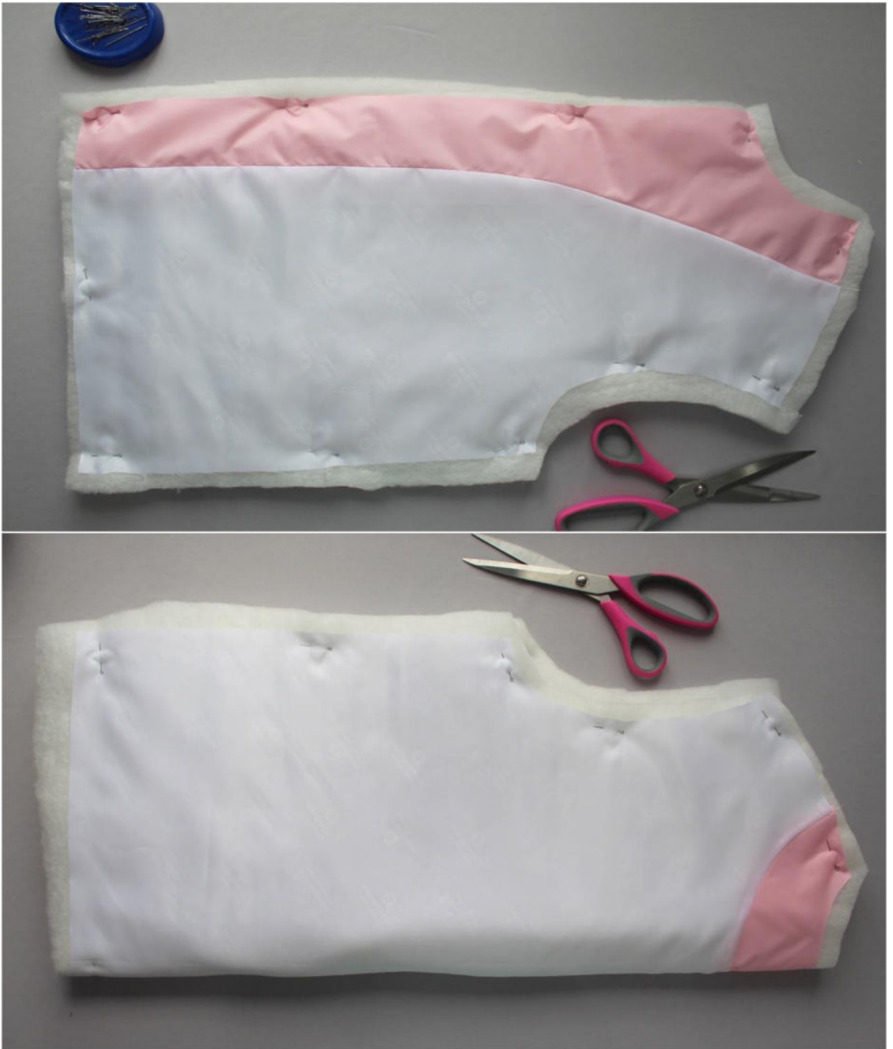
Настрочите детали на утеплитель.
