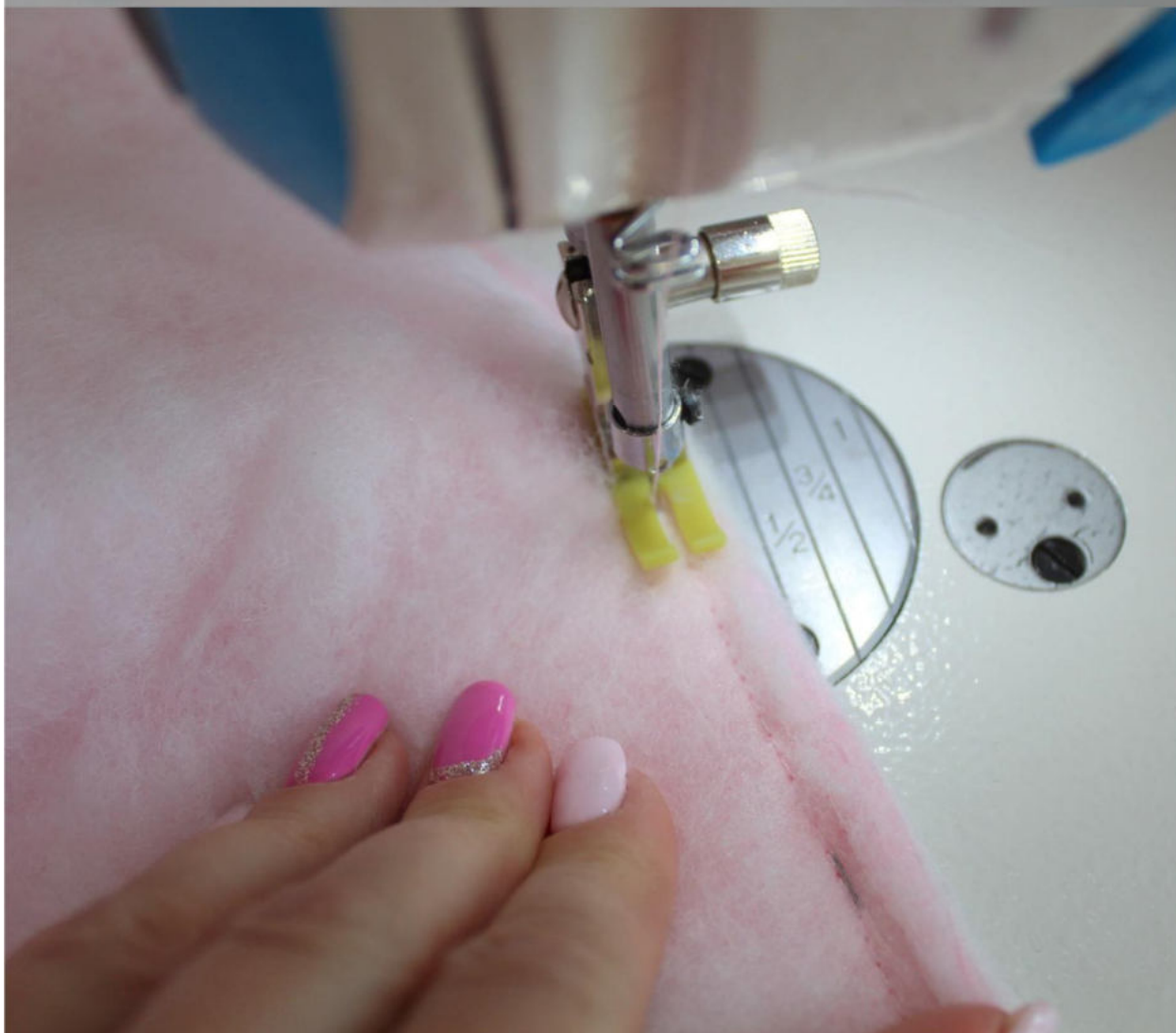
Высеките утеплитель по швам притачивания молнии.
