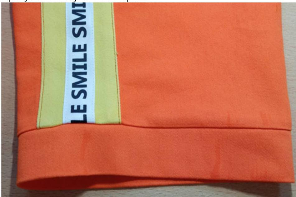
Уточните длину резинки на примерке, вставьте её в манжеты, сшейте концы в кольцо. Равномерно распределите сборку по манжетам. Ручными потайными стежками зашейте отверстия в манжетах.
