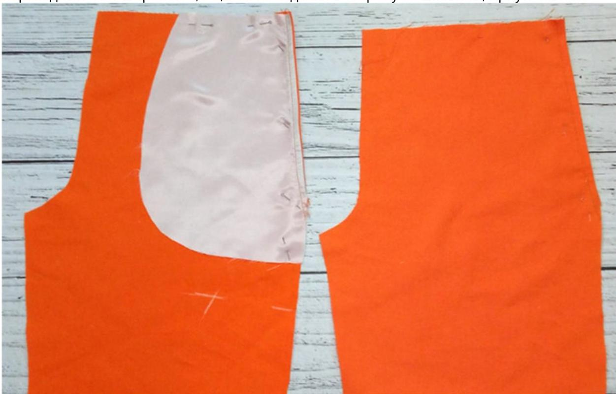
Отстрочите вход в карман на ширину лапки по лицевой стороне брюк, приутюжьте. Наметьте расположение входа в карман на лицевой стороне детали бочка. Наложите переднюю половинку на бочок, изнанкой на лицо, совмещая обработанный вход в карман с линией разметки, приколите насквозь булавками.
