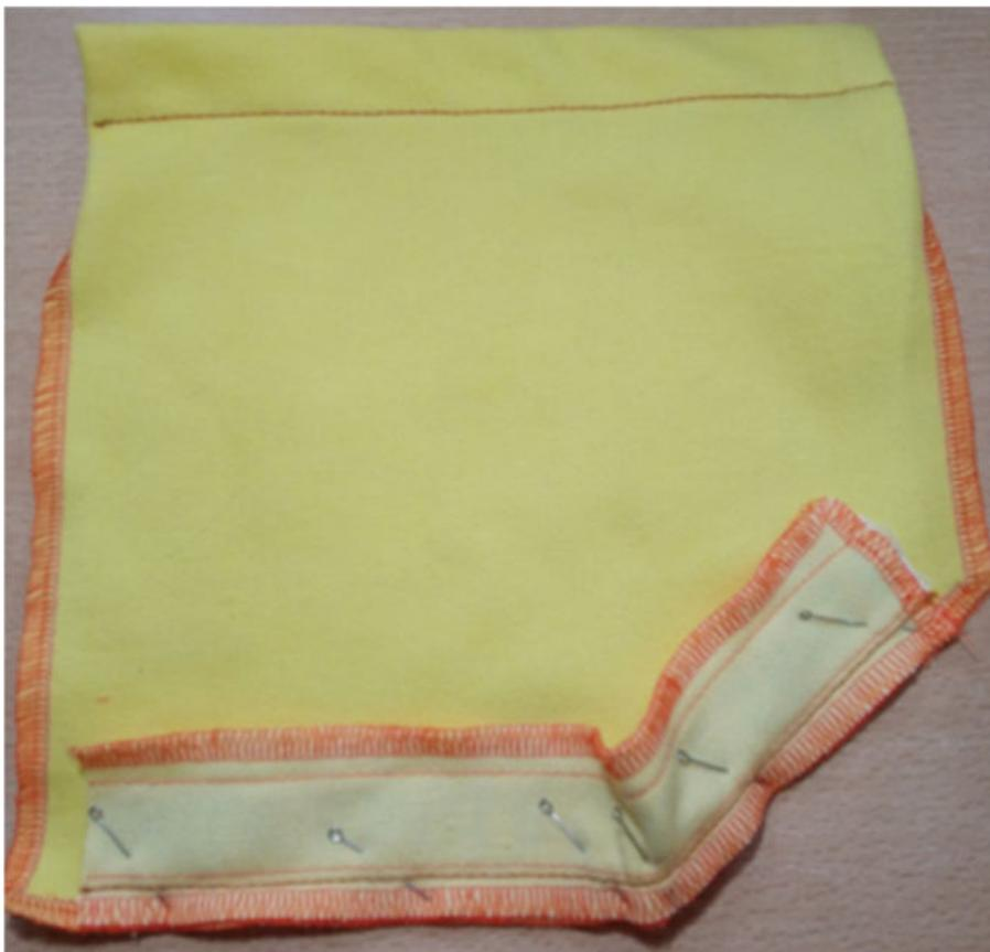
Выутюжьте шов притачивания доньшка на ребро (без переходного канта в какую-либо сторону), отстрочите в край по лицевой стороне кармана.
