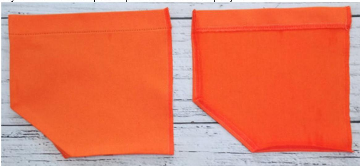
Наметьте расположение карманов на лицевой стороне задних половинок брюк. Наложите карманы по разметке, приколите, притачайте в край. Настрочите закрепки в уголках кармана. Приутюжьте карманы в готовом виде.
