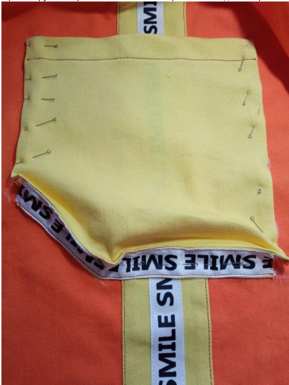
Настрочите саму деталь кармана на изделие, делая дополнительные закрепки возле швов притачивания донышка. Настрочите закрепки в уголках кармана.
