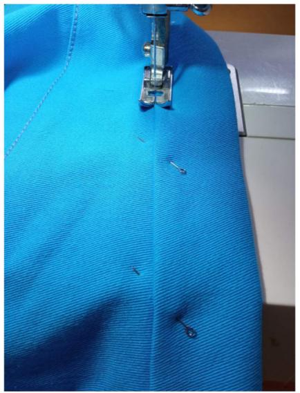
Уточните длину резинки на примерке. Вставьте её внутрь пояса, сшейте концы в кольцо. Равномерно распределите сборку по поясу. Ручными потайными стежками зашейте
