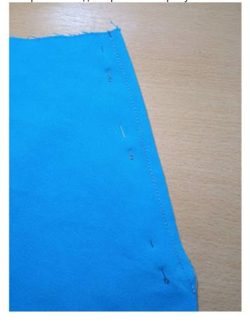
Наметьте расположение входа в карман на лицевой стороне детали бочка переда. Наложите деталь переда на бочок, изнанкой на лицо, краем обработанного кармана к линии разметки, заколите насквозь булавками.
