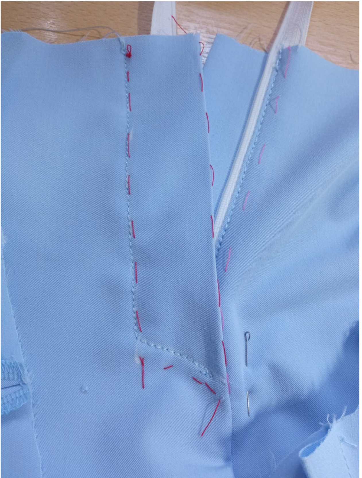
Частой зигзагообразной строчкой настройте закрепки в уступе гюльфика.
